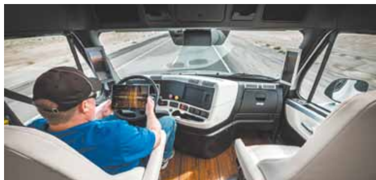
Highway Pilot - Tecnologia compreende um radar dianteiro e uma câmera
